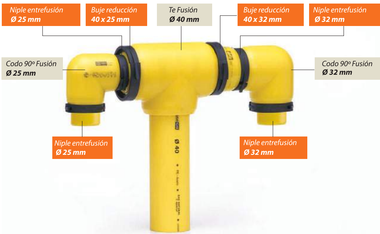
Reducción de diámetro y cambio de dirección combinando buje reducción de 40 x 25 mm y niple entrefusión de 25 mm
